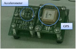
Figure VI. Sensor module
